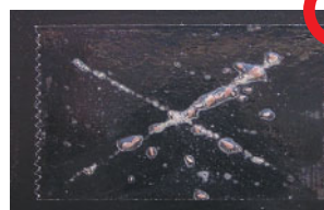
〈3〉 剥がしたセロテープに付着した塗膜の状況で判断(暗色系の下地の上に置く)
