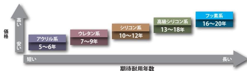
キクスイロイヤルセラクリヤーは汎用シリコン樹脂クリヤーよりも耐久年数が長い、高級シリコン樹脂を使用しているため、より長く外壁を保護します。
