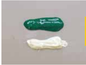
主剤と硬化剤を絞り出し、同じくらいの長さで取り出します。
