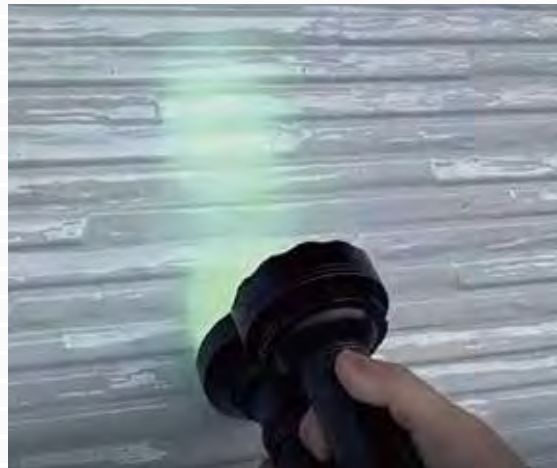
ブラックライトで塗布状態を瞬時にチェック 推奨：ブラックライト 100LED型
