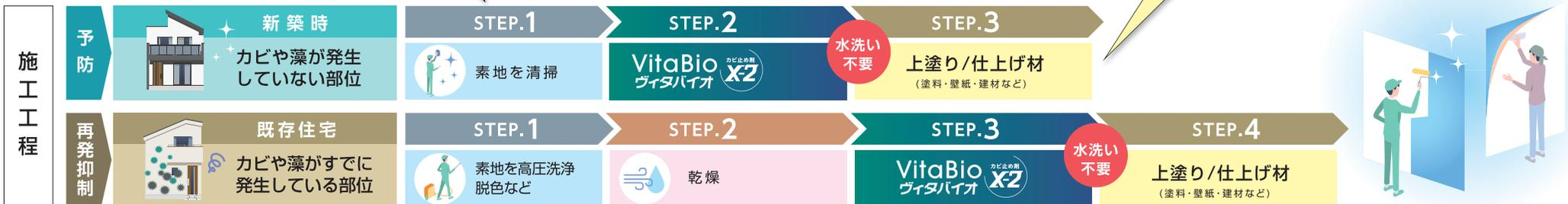
※有効成分によるカビ・藻の抑制効果を維持するために、必ず仕上げ材(塗料・壁紙・建材など)でヴィタバイオカビ止め剤X-2施工面を保護してください。
