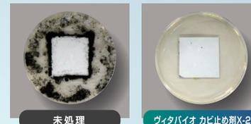
アルミ板に水性塗料を塗布し、5種混合菌(カビ)を培養。その後、試験片に生育したカビを拭きとり、乾燥後の試験片両面に0.1mlの「ヴィタバイオカビ止め剤X-2」下地処理剤を塗布。28℃で2週間カビを培養し、繁殖状況を観察した。ヴィタバイオカビ止め剤X-2は優れたカビ抑制効果が認められた。
