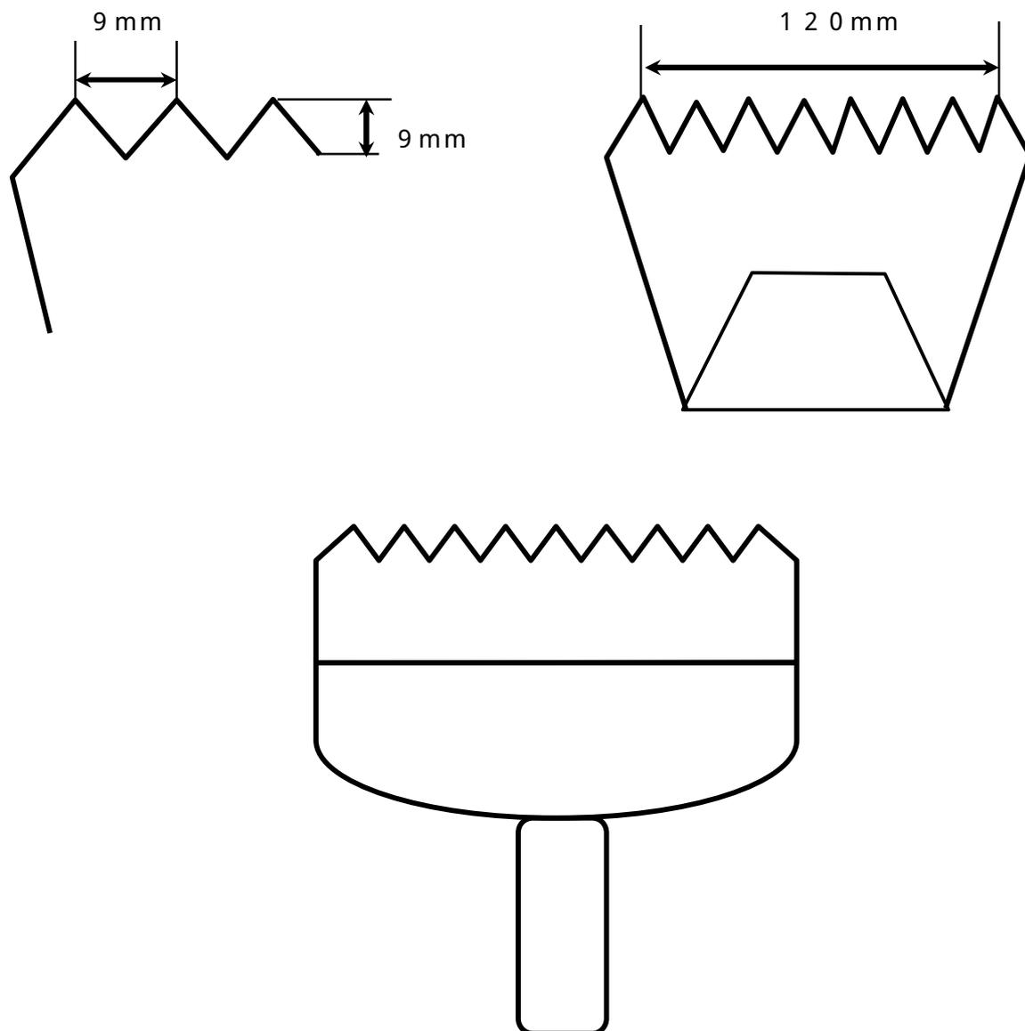
・校倉専用クシ目ゴテのピッチに合わせて、金切りバサミでカットします。
