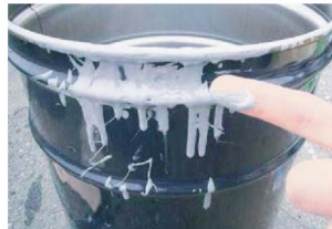
容器の外側に塗料が付着している状態。
