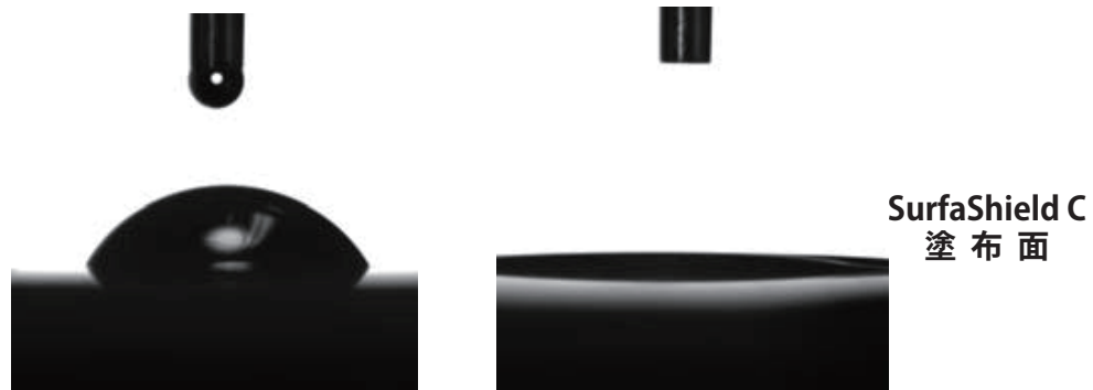
図：水滴とガラスの接触角度（顕微鏡写真）
