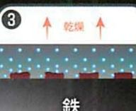
③塗料の乾燥過程で、非常に付着性の高い樹脂と特殊防錆顔料によって、サビた鉄面はしっかりと覆われ、ち密な塗膜を形成していきます。
