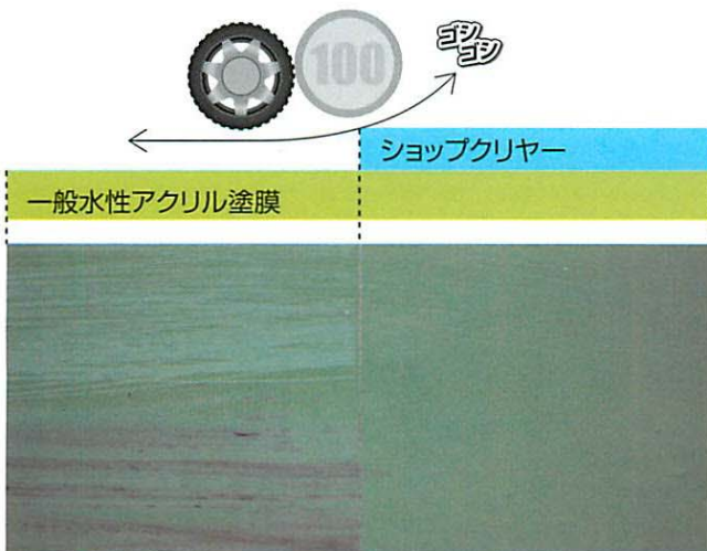
上図は一般水性アクリル塗料の上にショップクリヤーを塗装してタイヤ片及びコインで擦りつけたときの汚染及び擦り傷の状態を表しています。
