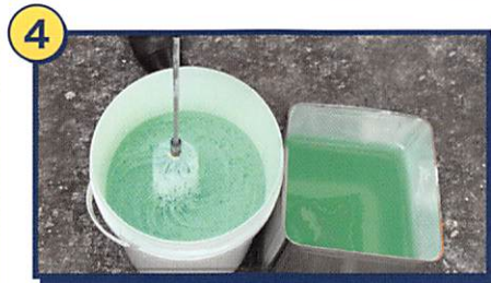
次に、水をはったバケツ内で回転させ洗浄します。
