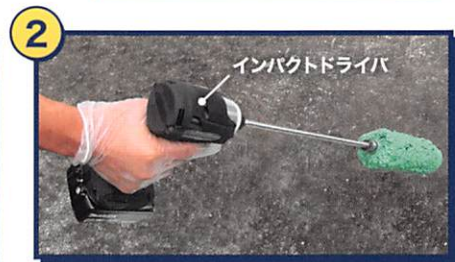
①をお手持ちのインパクトドライバに装着します。
