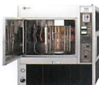
太陽光・温度・湿度・降雨などの屋内外の条件を人工的に再現し促進的に耐候性を評価。
