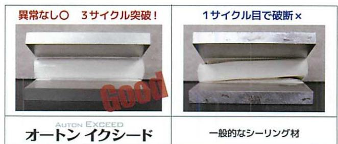
30年想定の究極の繰返し試験「圧縮拡大30% 4,000回×3」を突破する耐久力を実現！
