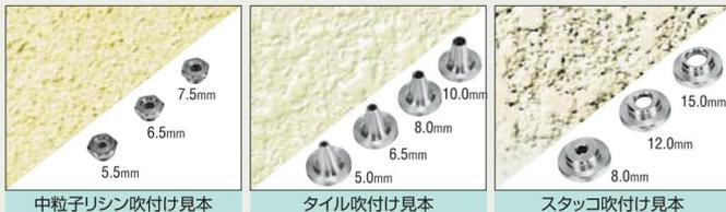
塗料名、塗料粘度、骨材の大きさ、模様によりスプレーガンおよび塗料ノズル口径を決めてください。また、塗料カタログに標準仕様が明記され、スプレーガン名、口径、吹付圧力等が表示されていますのでご参照ください。
