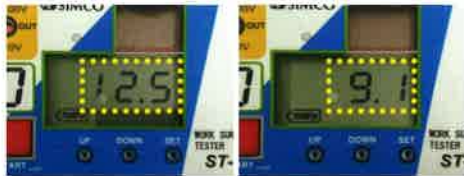
SIMCO製表面抵抗計による測定結果。 一般塗膜の約 1/2500 の電気抵抗値を実現。
