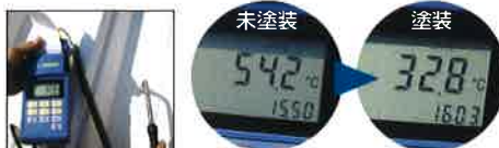
※スターコートを塗装している工場と未塗装の工場が隣接した状態で計測
