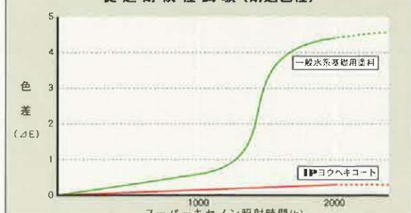
IPヨウヘキコートは、高耐候性顔料の採用に加え、特殊UV抑制効果(UVハイブリッド)により、設定色はもちろんのこと調色においても紫外線による塗膜劣化を最小限に抑えます。
